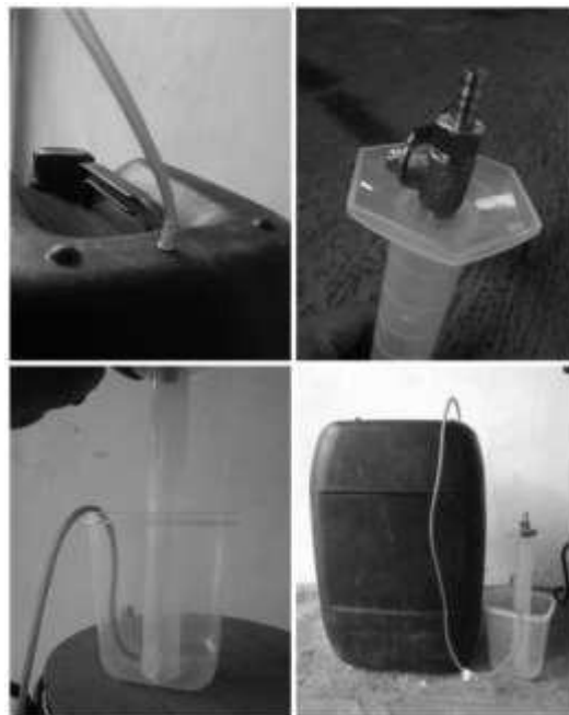
Gambar 3. Fermentor yang dilengkapi perangkat pengukur volume produksi biogas dan perangkat uji nyala.
